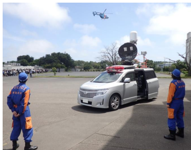
応急通信対策車立上げ訓練 都道府県警察ヘリコプターからの受信映像を衛星設備により警察本部等に伝送
